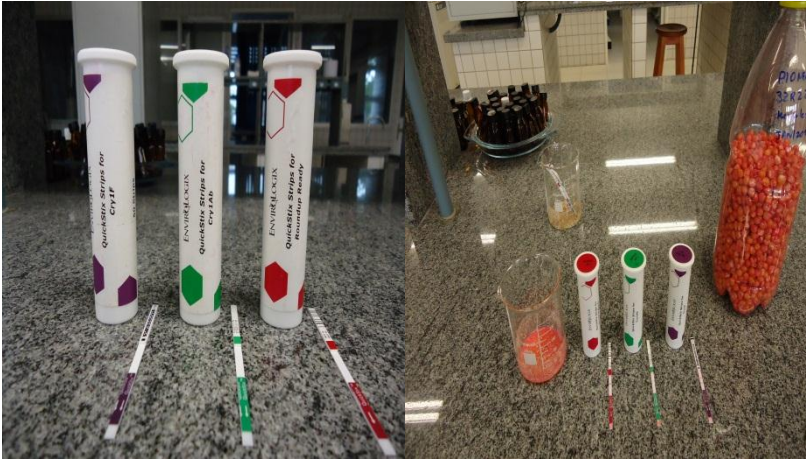
Figura 8 – Ensaio imunocromatográfico para a detecção de OGMs na farinha da variedade milho transgênico Pioneer (P32R22H)
