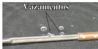
Figura 4.10: Fotografia durante um teste de estanqueidade.
