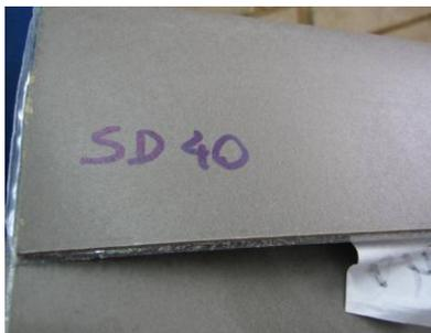
Figura 25 - Material viscoelástico modelo SD 40 do fabricante 3M.
