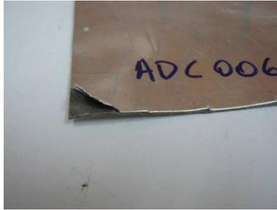
Figura 26 – Material ADC 006 (Configuração do material SD 40 com camada de alumínio de 0,1mm de espessura).
