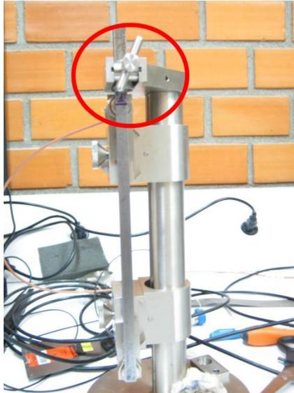
Figura 21 - Detalhe do parafuso de fixação do sistema B&K 3930.
