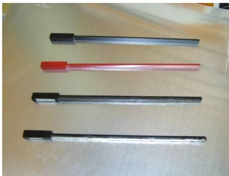
Figura 13 – Vigas para ensaio Oberst.
