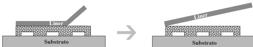
Figura 12 - Remoção do liner protetor
