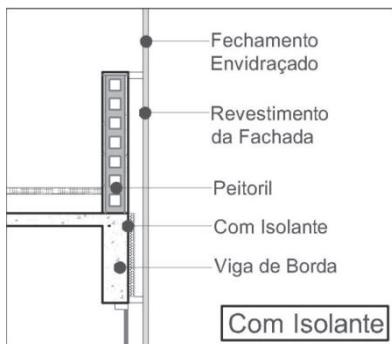
Figura 25 - Corte esquemático da fachada com pele de vidro com isolante
