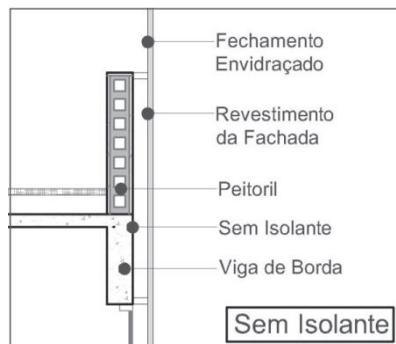
Figura 26 - Corte esquemático da fachada com pele de vidro sem isolante
