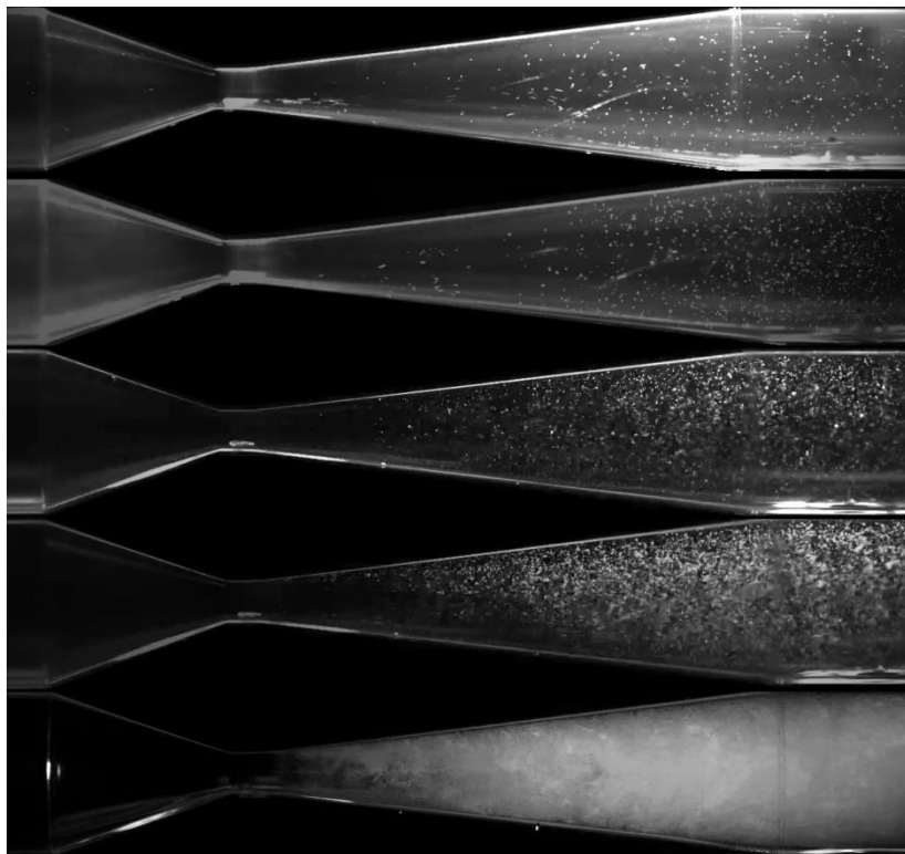
Figura 4.4 – Imagens capturadas com a câmara de alta velocidade para diferentes concentrações mássicas de refrigerante. As imagens referem-se, na sequência de cima para baixo, aos casos 1 ( 16,1\% \text{ kg}_{\text{R-134a}}/\text{kg}_{\text{mistura}} ), 2 ( 21,7\% \text{ kg}_{\text{R-134a}}/\text{kg}_{\text{mistura}} ), 3 ( 30,1\% \text{ kg}_{\text{R-134a}}/\text{kg}_{\text{mistura}} ), 4 ( 39,4\% \text{ kg}_{\text{R-134a}}/\text{kg}_{\text{mistura}} ) e 5 ( 46,7\% \text{ kg}_{\text{R-134a}}/\text{kg}_{\text{mistura}} ).
