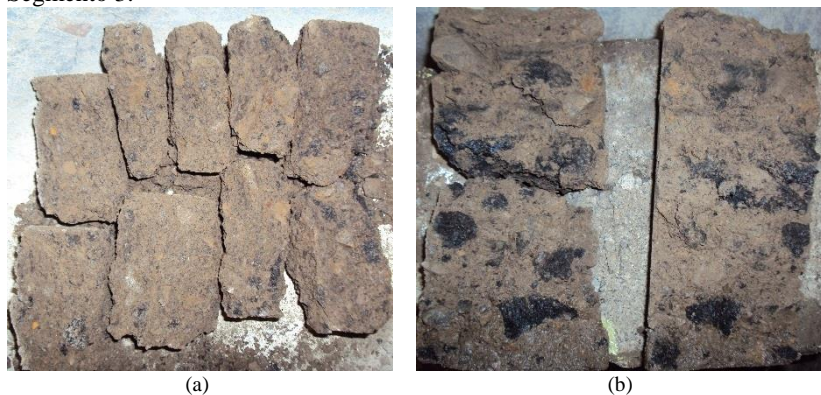
Figura 93: Características visuais da mistura reciclada (a) Segmento 1 (b) Segmento 3.
