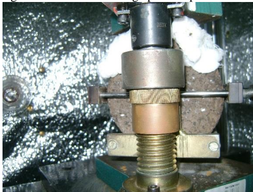
Figura 62: Ensaio de fadiga por compressão diametral.
