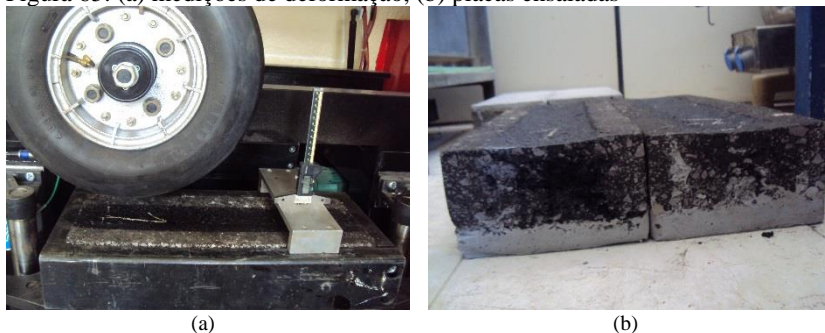
Figura 65: (a) medições de deformação, (b) placas ensaiadas
