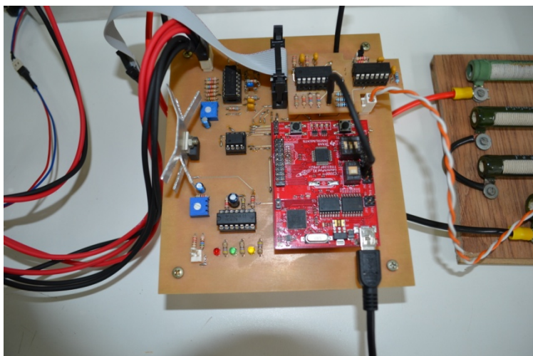
Figura 5.18: Placa de condicionamento e controle.
