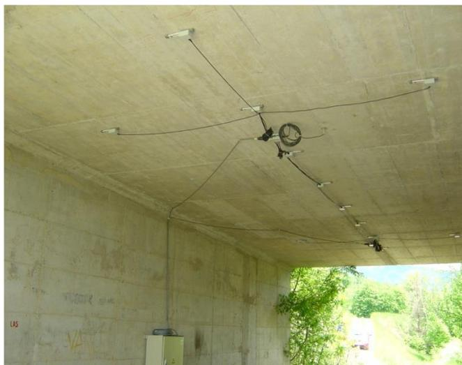
Figura 45 – Sensores SiWIM instalados sob a ponte (FAVAI, 2006 apud DNIT 2008).
