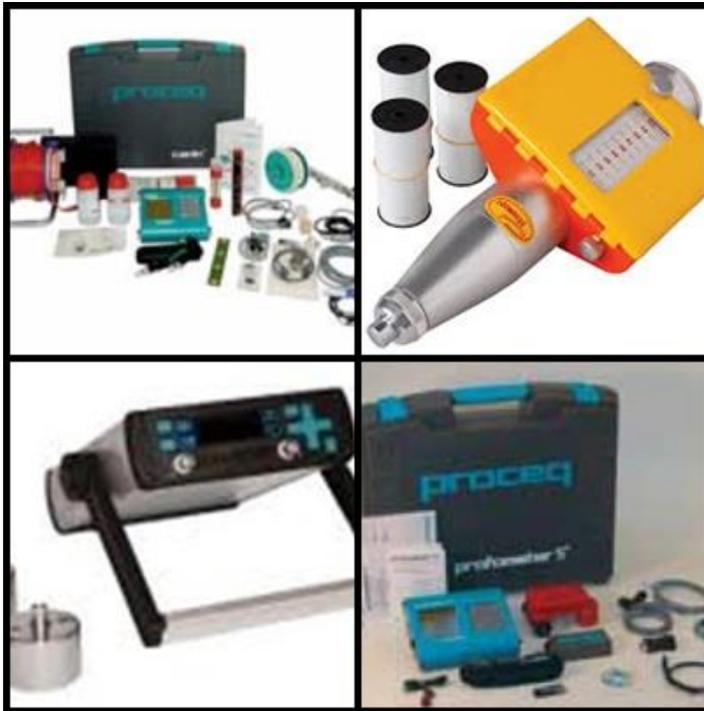
Figura 18 - Canin+, Esclerômetro, Ultrassom e Profometer
