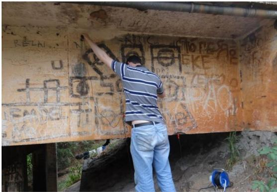
Figura 23 - Ensaio de potencial de corrosão utilizando sonda pontual
