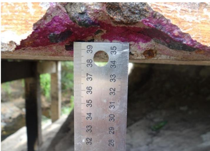
Figura 65 - Ensaio de carbonatação, V1 Sul
