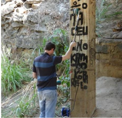
Figura 22 - Ensaio de potencial de corrosão utilizando sonda de roda
