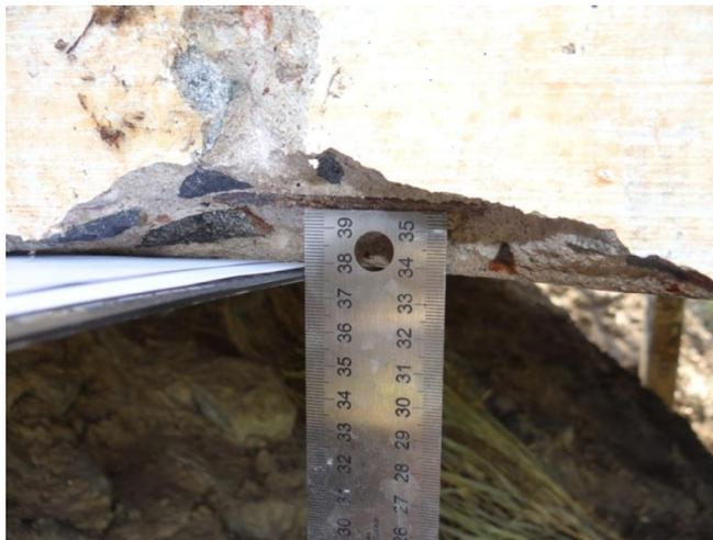
Figura 66 - Ensaio de carbonatação, V1 Norte
