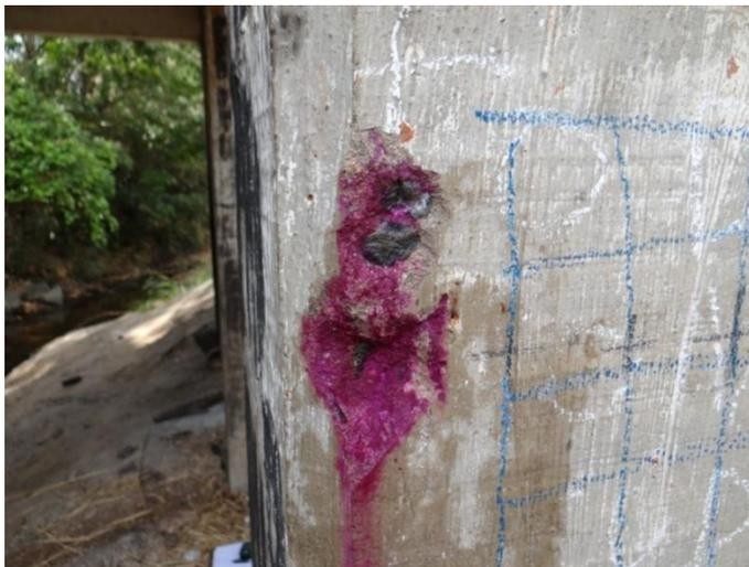
Figura 64 - Ensaio de Carbonatação, P1 Sul
