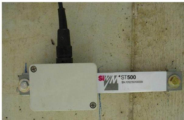
Figura 43 – Transdutor de deformação instalado (DNIT, 2008).
