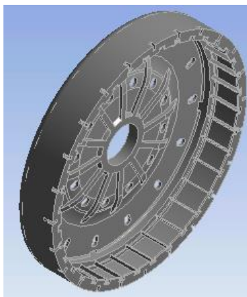
Figura 18 - Moldura plástica do rotor.
