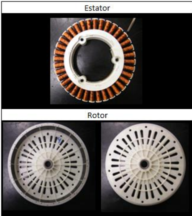
Figura 3 - Estator e Rotor.
