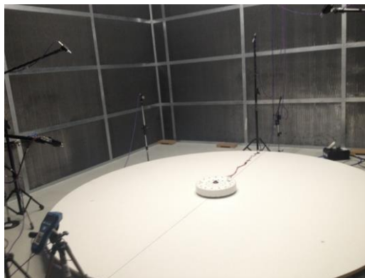
Figura 58 - Experimento de medição da potência sonora do motor.
