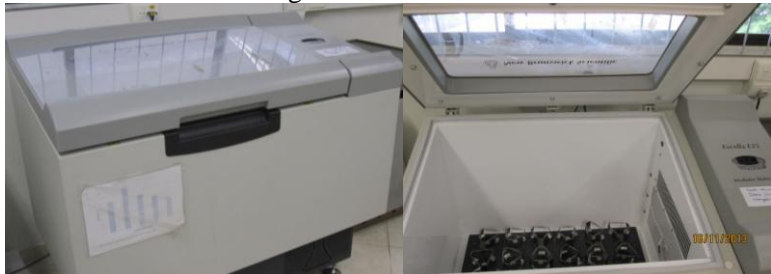
Figura 6 - Shaker com agitação orbital, usando no ensaios para síntese enzimática de acetato de eugenila
