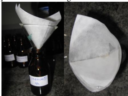
Figura 8 - Filtração do acetato de eugenila com hexano em papel filtro.
