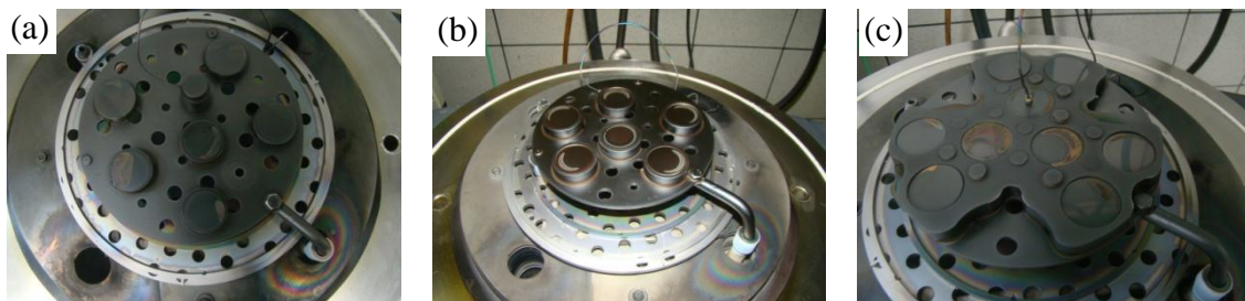
Figura 10: Diferentes geometrias utilizadas para a deposição do filme de DLC. a) sem anel de proteção; b) com o anel; c) suporte inteiro *Fonte: Autoria própria
