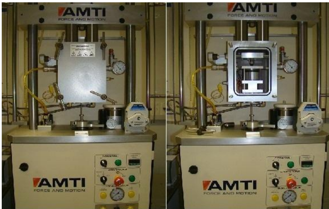
Figura 12: Tribômetro AMTI com a câmara de ensaio fechada e aberta, respectivamente.
