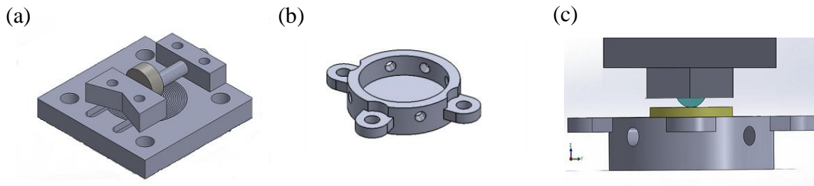
Figura 13: Representação esquemática do suporte para (a) contra-corpo (b) corpo e (c) corpo e contra-corpo.
