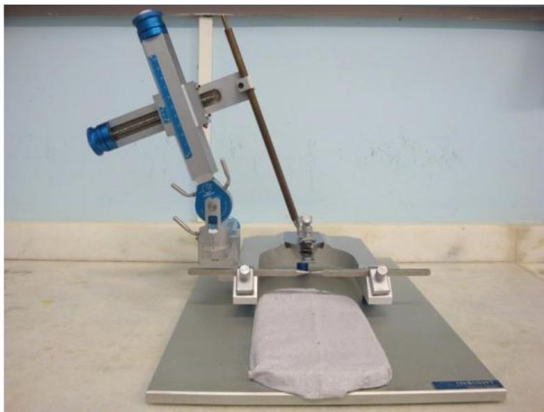
**Figura 3:** Aparelho estereotáxico.
