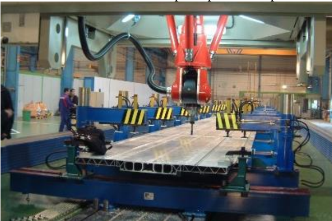
Figura 10 - Cinemática "híbrida" Tricept acoplada a um portal elevado.
