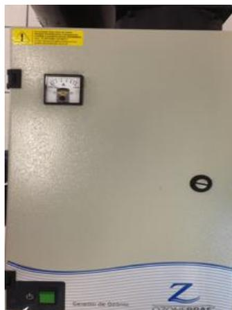
Figura 24 – Quantidade de ozônio gerado correspondente ao fluxo de alimentação de oxigênio para o equipamento Z400 – corrente elétrica de 5,8 A no painel.
