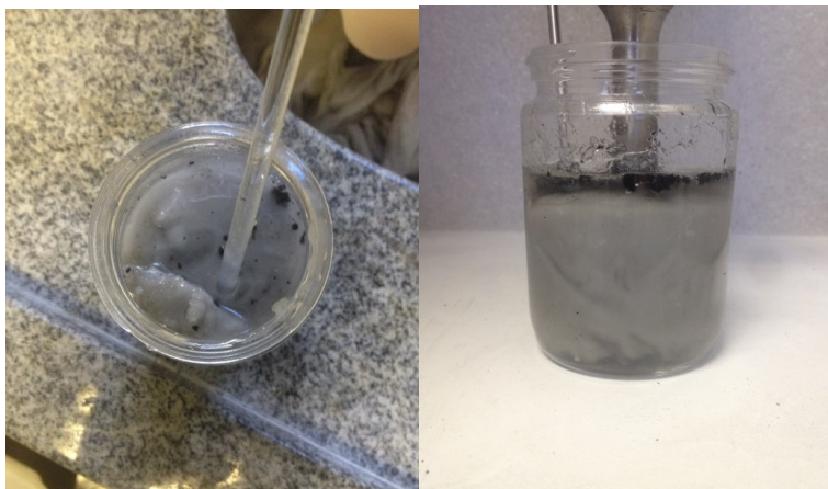
Figura 6 – Aspecto da mistura com os NTC adicionados diretamente na solução de silicato e hidróxido de sódio, após sonicação.
