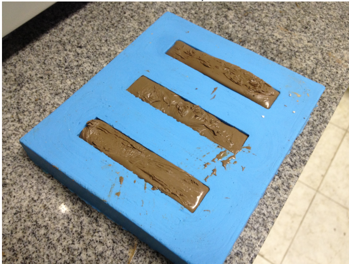
Figura 18 – Aspecto da moldagem dos corpos de prova com aditivo policarboxilato mostrando a ausência exsudação dos NTC.
