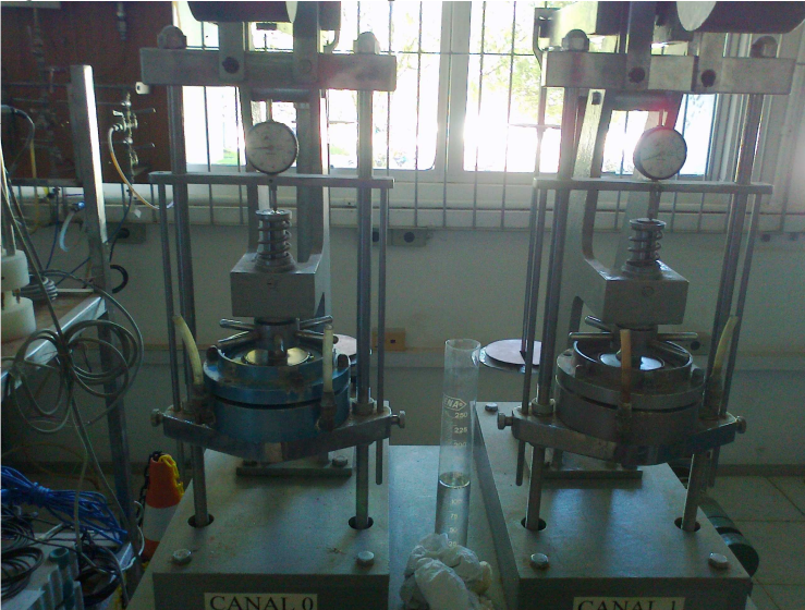
Figura 42 Ensaio edométrico de duplo anel
