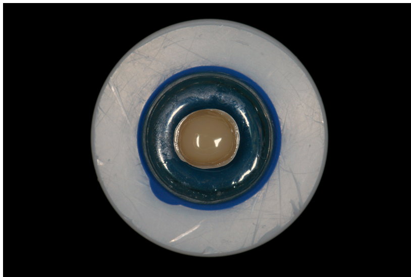
Figura 9 Corpo de prova mantido no interior do suporte. Note que após presa, o material de moldagem foi capaz de simular a presença do ligamento periodontal com ~1 mm de espessura.
