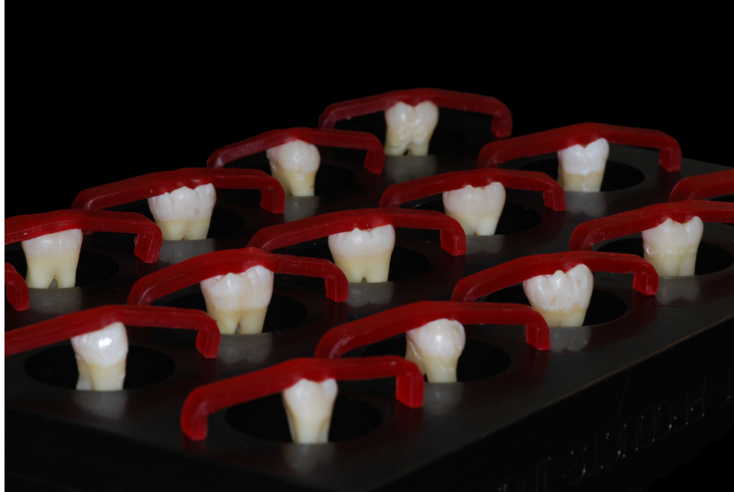
Figura 2 Dispositivo utilizado para inclusão dos dentes em resina epóxi.
