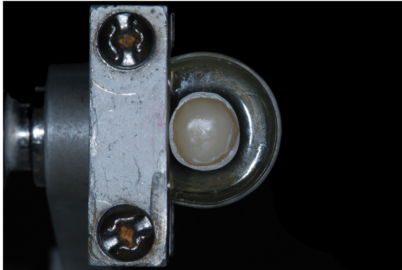
Figura 11 Corpo de prova fixado à máquina de cortes Isomet.
