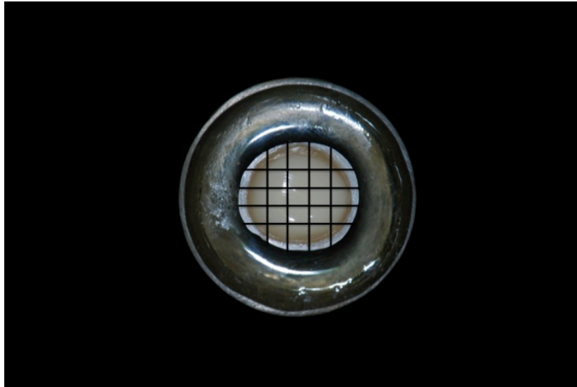
Figura 14 Cortes sequenciais nos eixos X e Y, distantes 1.2 mm entre si, para obtenção de filetes com dimensão \sim 0.9 \text{ mm}^2 .
