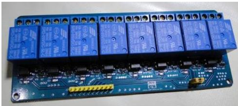
Figura 18 - Placa seletora Relé de 8 canais.
