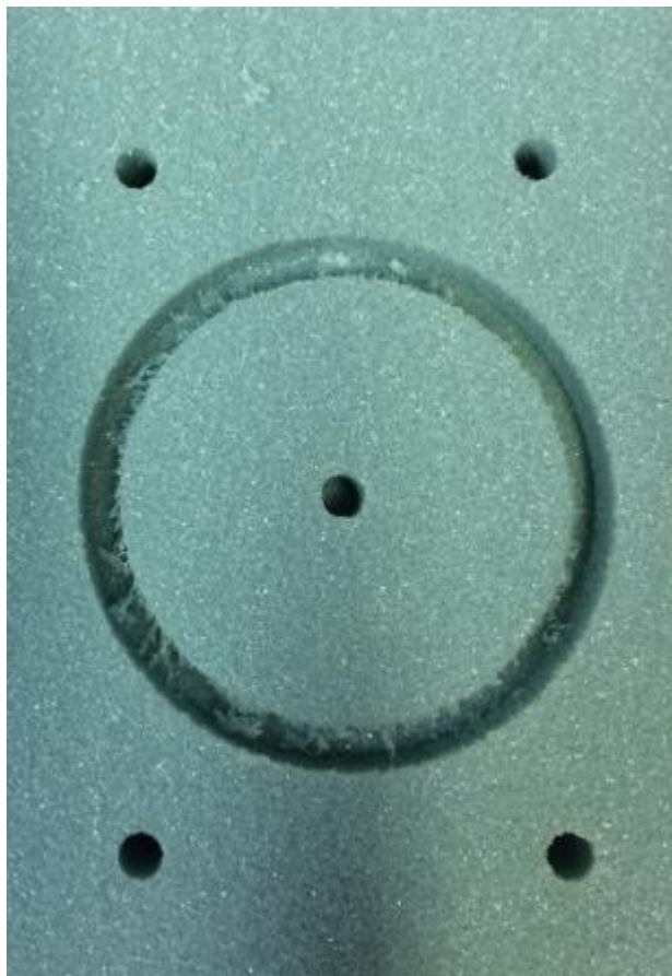
Figura 44 - Usinagem em espuma de PVC do padrão STEP-NC no processo de furação.
