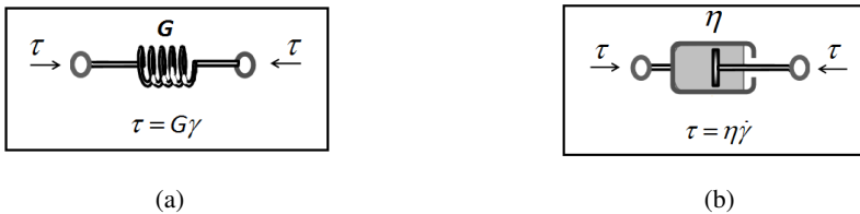
Figura 4 – Representação do comportamento reológico ideal: (a) Sólido elástico linear, (b) Fluido viscoso newtoniano
