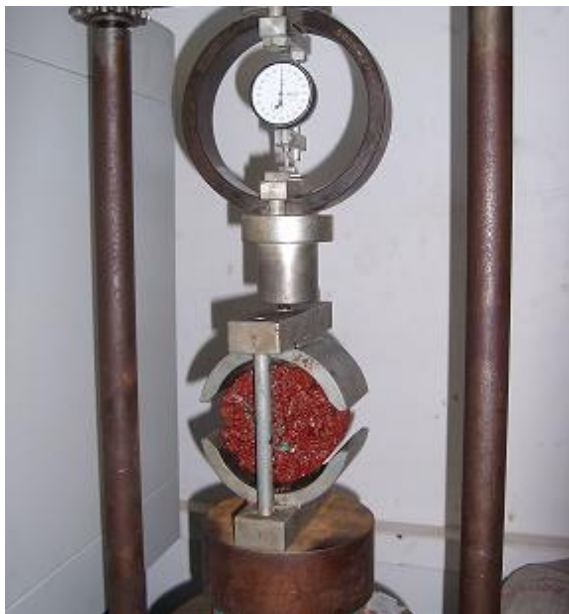
Figura 6.46 – Ensaio de resistência à tração da mistura Vermelho A.
