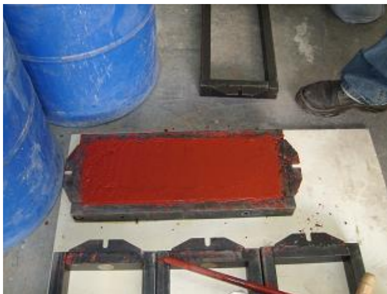
Figura 6.32 – Moldagem das placas de mistura de concreto Portland Vermelho denso.
