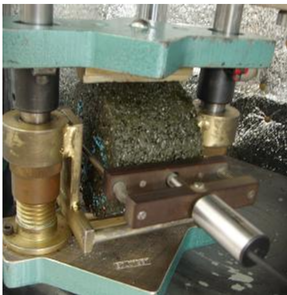
Figura 6.47 – Ensaio de módulo de resiliência da mistura Verde.
