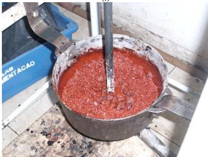
Figura 6.15 – Processo de usinagem da mistura Vermelho B: adição do pigmento (f); mistura colorida pronta (g).
