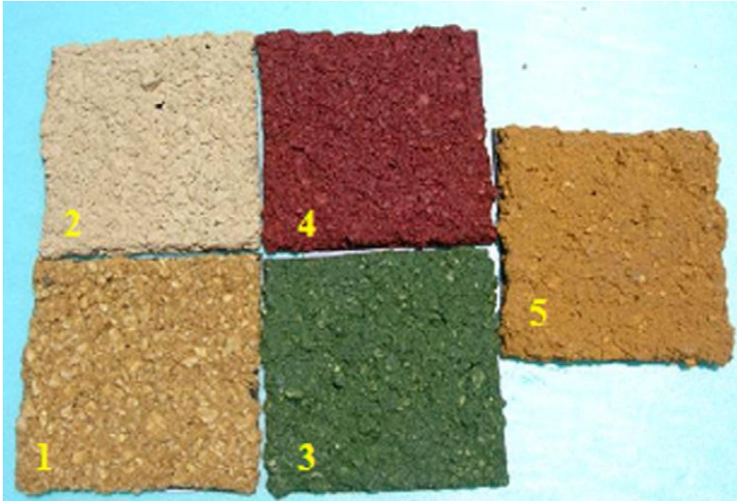
Figura 4.11 - Amostras de mistura asfáltica colorida (1 bege, 2 branco, 3 verde, 4 vermelho, 5 amarelo).
