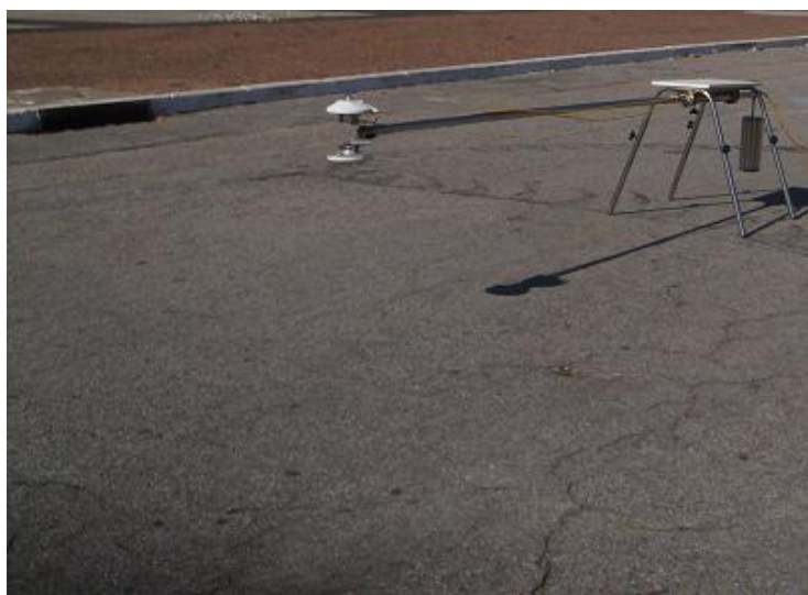
Figura 6.38 – Medição da refletância dos revestimentos envelhecidos: mistura asfáltica convencional (a).
