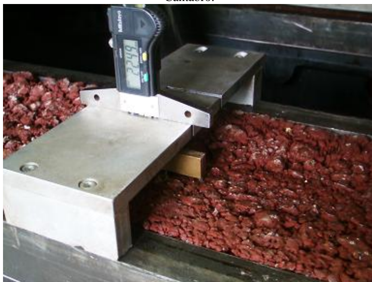
Figura 6.49 – Medição da trilha de roda durante o ensaio de deformação permanente.
