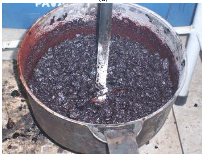
Figura 6.14 – Processo de usinagem da mistura Vermelho B: adição do agregado miúdo (d); mistura sem pigmento (e).
