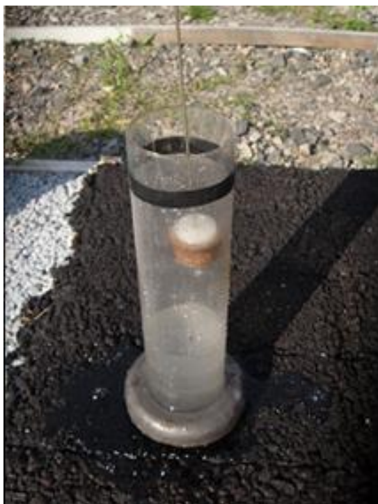
Figura 6.42 – Ensaio de drenabilidade.
