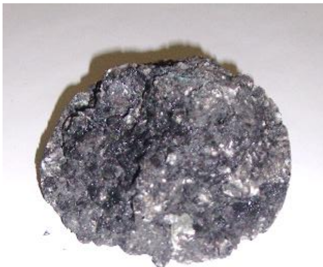
Figura 6.48 – Aparência da misturas CPA de Referência após o ensaio C&A.
