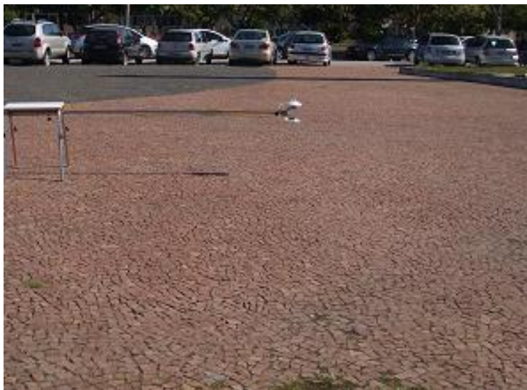
Figura 6.40 – Medição da refletância dos revestimentos envelhecidos: pedra petit pavê vermelha (d).
