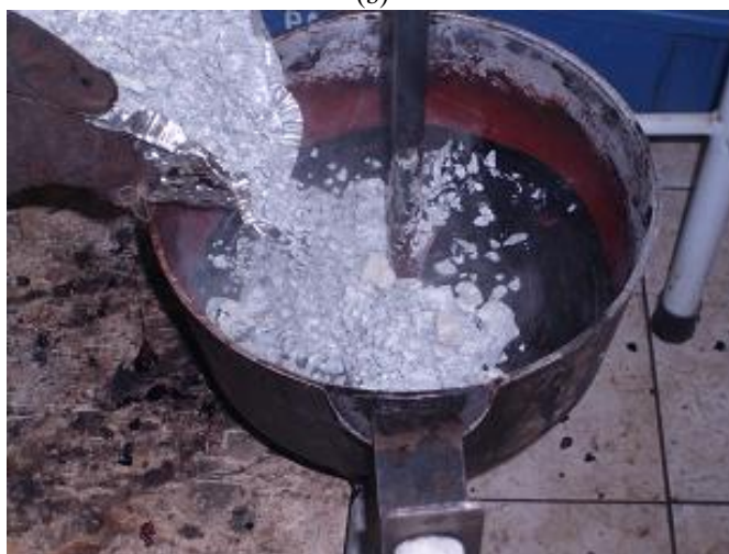
Figura 6.13 – Processo de usinagem da mistura Vermelho B: pesagem do ligante (b); adição do agregado graúdo (c).
