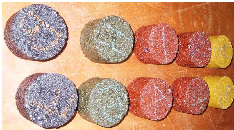
Figura 6.17 – Corpos de prova com 100 mm de diâmetro, de esquerda para a direita mistura: Referência, Verde, Vermelho A, Vermelho B e Amarelo-albino.
