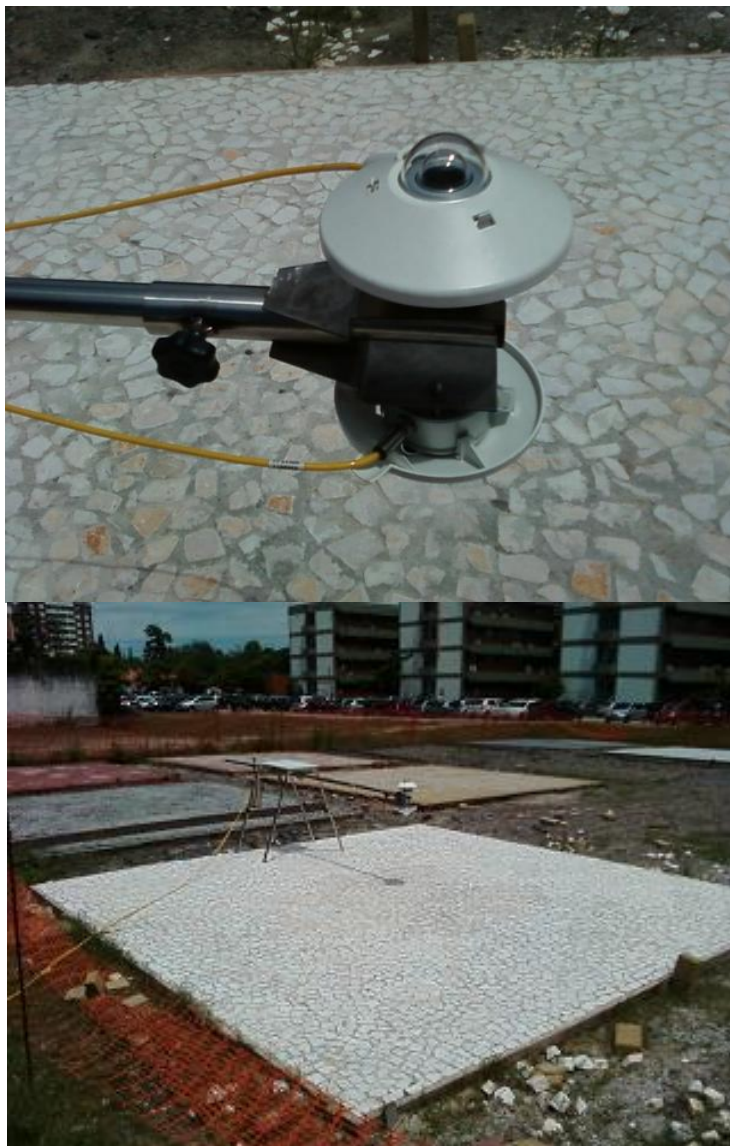
Figura 6.34 – Piranômetro (a) e a disposição do mesmo (b) durante os ensaios de refletância em campo.
