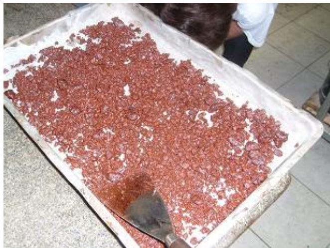
Figura 6.16 – Processo de usinagem da mistura Vermelho B: mistura na bandeja para envelhecimento a curto prazo (h).
