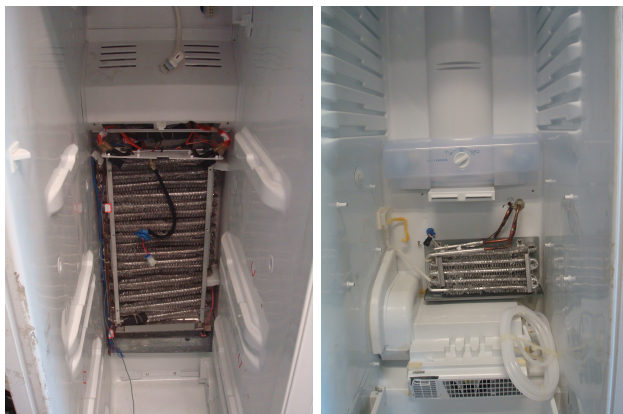
Figura 14 – Evaporadores - congelador à esquerda e refrigerador à direita.
