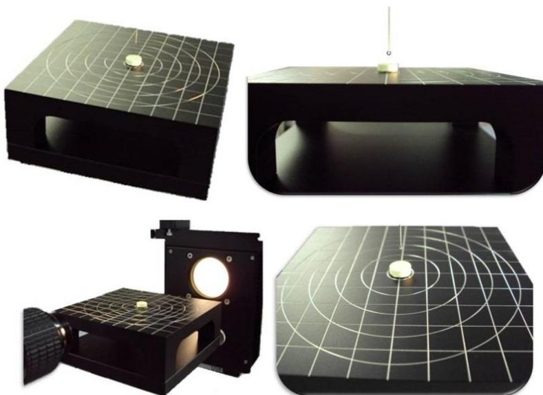
**Figura 34 - Representação da determinação de ângulo de contato.**
