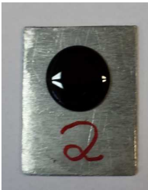
Figura 6.8 - Porta amostra de alumínio com a amostra de ligante asfáltico.
