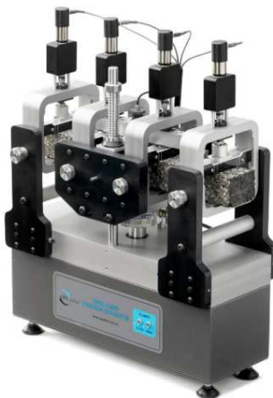
Figura 5.18 - Aparato de teste 4 pontos para ensaio de módulo complexo e resistência à fadiga.
