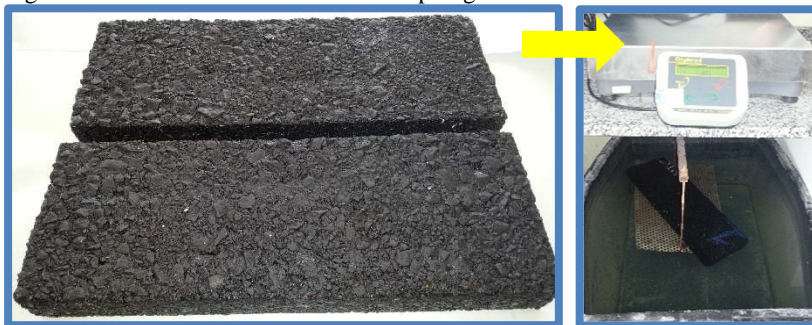
Figura 6.26 - Placas de 50 x 18 x 5 cm e pesagem hidrostática.
