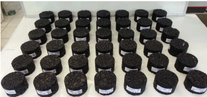
Figura 6.21 - Total de corpos de prova moldados para o ensaio de Lottman modificado.
