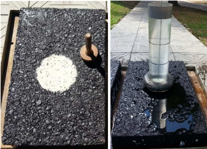
Figura 6.27 - Ensaio de mancha de areia e drenabilidade sobre placas de concreto asfáltico.
