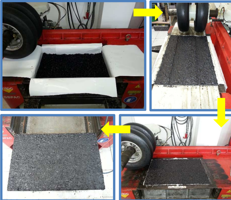
Figura 6.25 - Processo de compactação de placas (60 x 40 x 9 cm).
