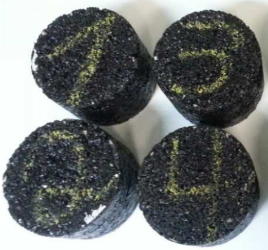
Figura 6.15 - Corpos de prova obtidos na compactação giratória.
