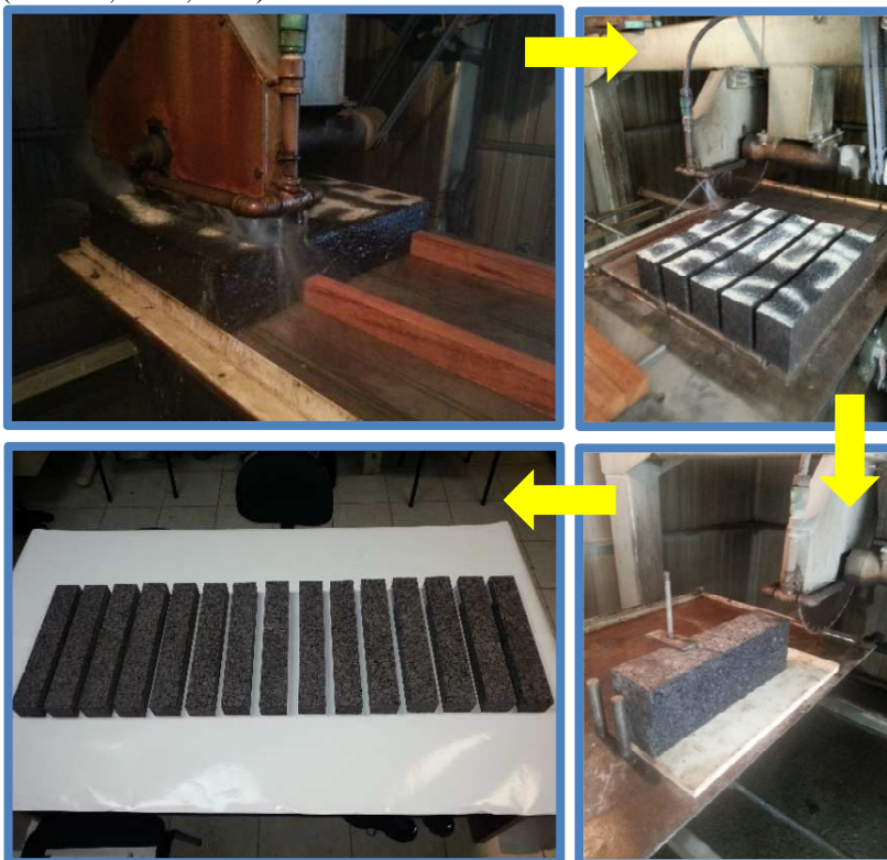
Figura 6.28 - Serragem das placas para obtenção de corpos de prova prismáticos (381 x 63,5 x 50,8 mm).
