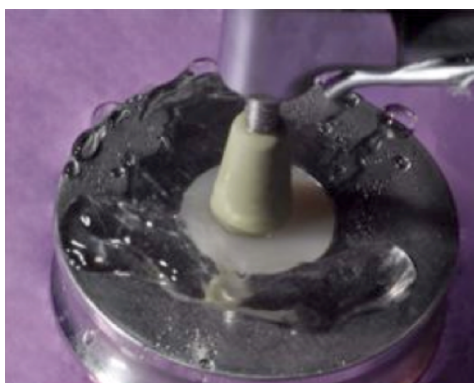
Figura- 2) Polimento do corpo de prova, com refrigeração, utilizando a taça de polimento Optrapol.
