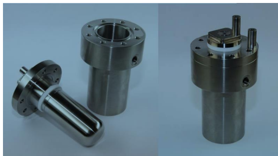
Figura 10 – Célula de medição de propriedades elétricas proposta por Feja (2012). A foto da esquerda mostra os eletrodos desmontados e a da direita os eletrodos encaixados.
