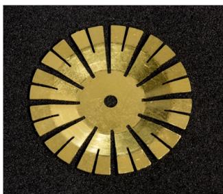
Figura 24 – Placa de ouro para correção da medição de impedância
