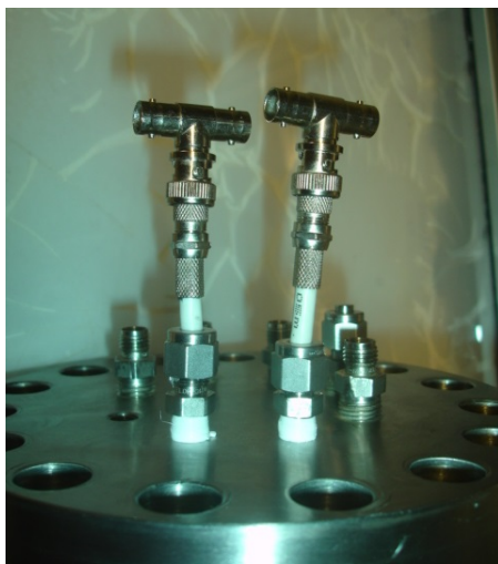
Figura 20 – Conexões feedthrough fixadas à tampa
