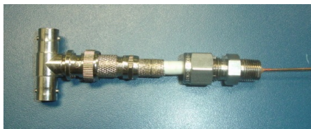
Figura 19 – Conexão feedthrough com o cabo coaxial montado
