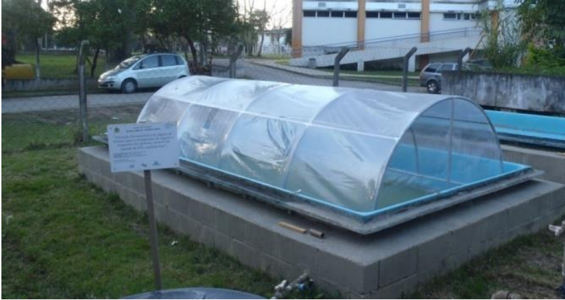
Figura 6. Imagem do sistema na fase I, com cobertura de vinil transparente.
