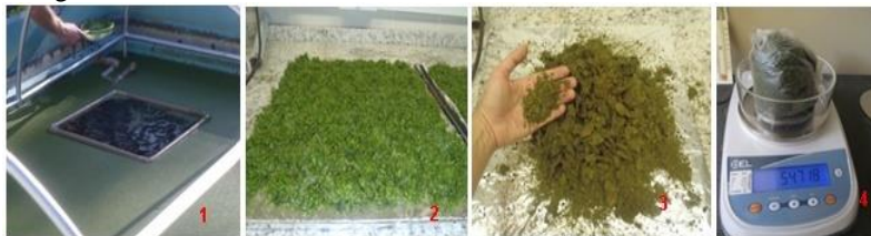
Figura 10. Coleta da biomassa; 2-Secagem da biomassa; 3- Biomassa seca; 4- Pesagem da biomassa seca.
