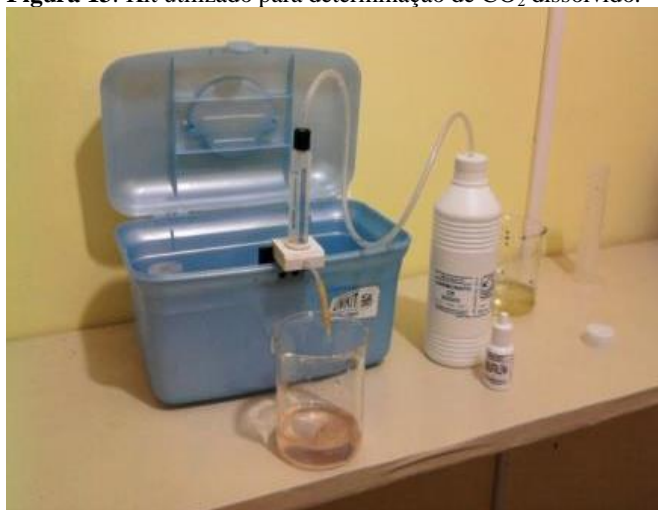
Figura 13. Kit utilizado para determinação de CO 2 dissolvido.
