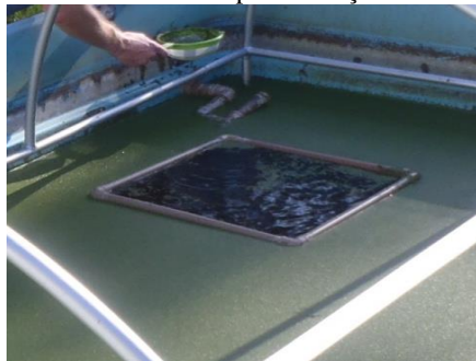
Figura 9. Método utilizado para medição da densidade de lemnas nos reatores.
