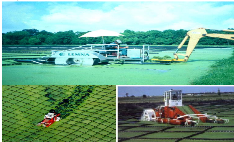
Figura 2. Colheitadeira flutuante em lagoas de tratamento com lemnas (acima). Abaixo: Lagoas de para tratamento terciário de esgoto doméstico, na Carolina do Norte – USA (LemnaTec®). (Fonte: Iqbal, 1999 e Lemna Technologies 2005)
