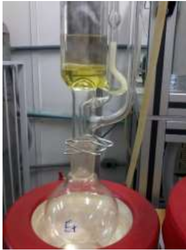
Figura 5: Extração de torta de chia em Soxhlet
