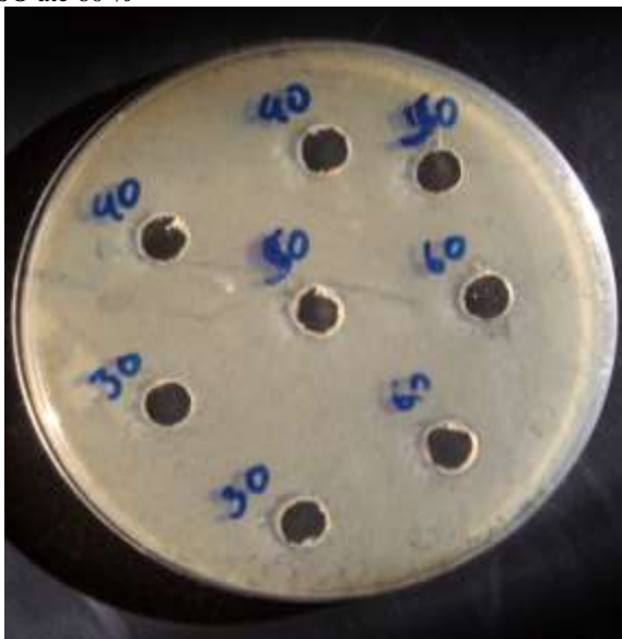
Figura 11: Placa de teste apresentando ausência de halos de inibição para soluções de DMSO até 60 %
