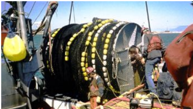
Figura 19 – Foto ilustrativa de uma rede de cerco enrolada no tambor de rede.
