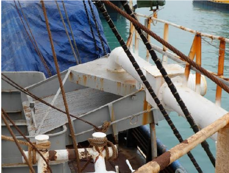
Figura 23 – Foto ilustrativa de um separador de água usado em embarcações de cerco peruanas.
