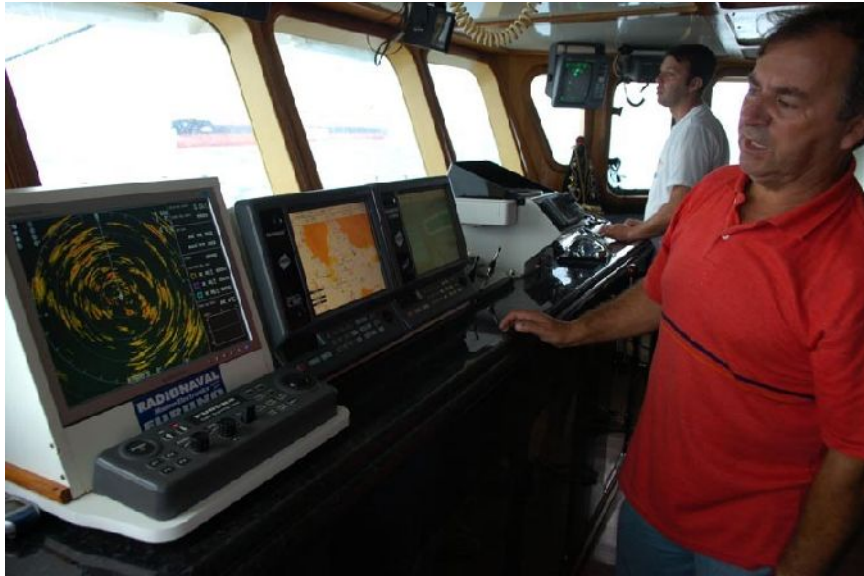
Figura 29 – Sala de comandos Mtanos Seif, o primeiro aparelho eletrônico na esquerda da foto é o sonar.
