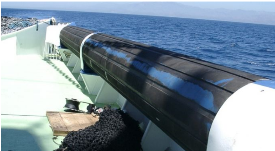
Figura 25 – Foto ilustrativa de um rolo de borda em uma embarcação de cerco.
