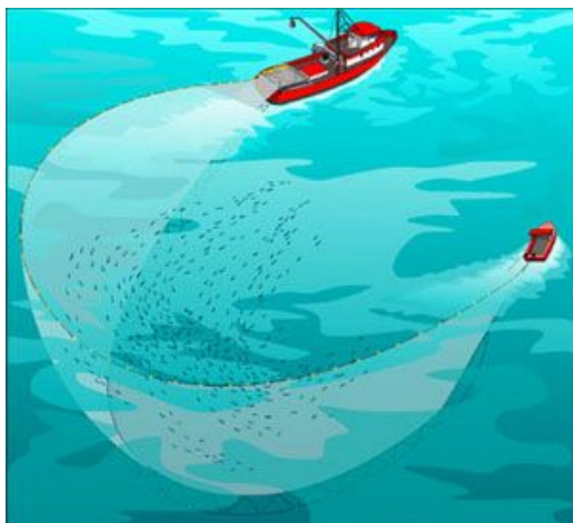
Figura 4 – Ilustração da embarcação principal circundando o cardume na operação do cerco.
