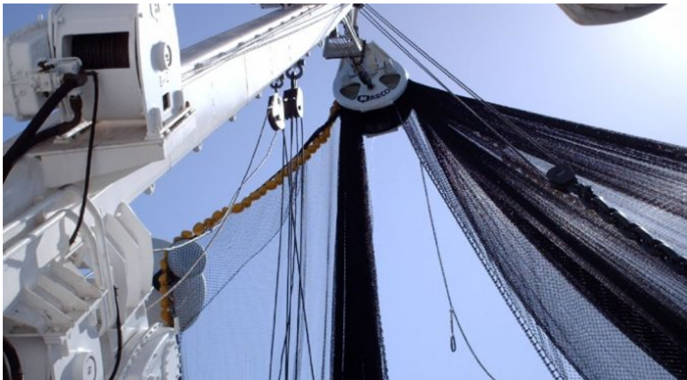
Figura 15 – Foto ilustrativa de um Power Block Marco em funcionamento.
