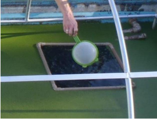
Figura 9: Quadrado flutuante em PVC, com área de 0,25m<sup>2</sup>.
