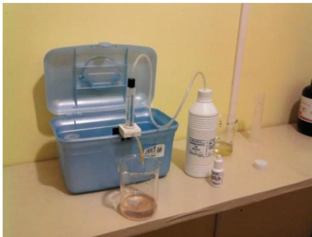
Figura 14: kit analítico para determinação de CO<sub>2</sub> dissolvido.
