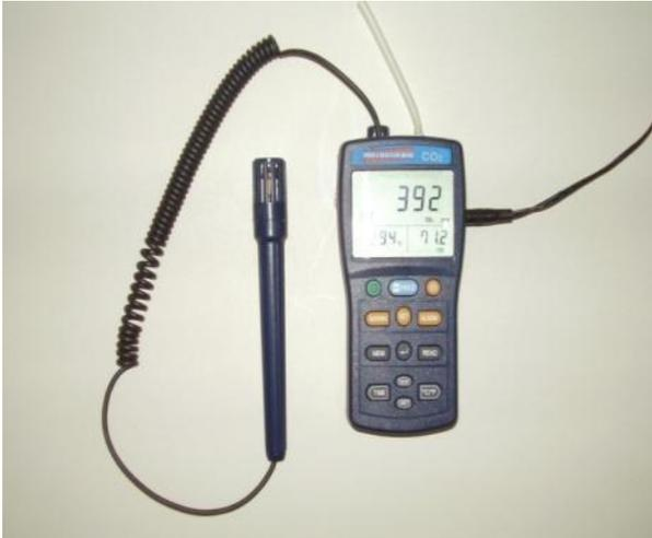
Figura 13: Analisador de Dióxido de Carbono Instrutherm C-02, detalhe para a mangueira conectada ao sensor do aparelho.
