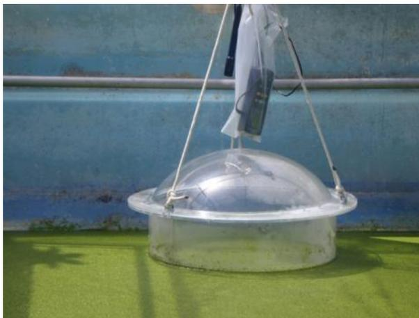
Figura 12: Câmara de fluxo estática instalada na lagoa, juntamente com o analisador de CO<sub>2</sub>.
