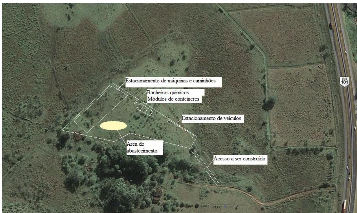
Figura 01 – Layout do Canteiro de obras UFSC
