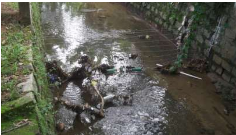
Figura 5. 1. Tela de monitoramento após primeiro evento de precipitação.
