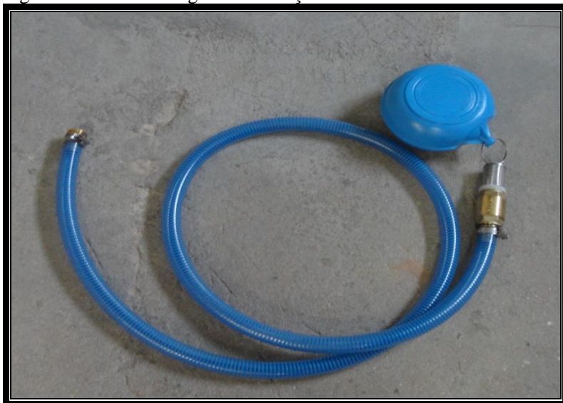
Figura 24 - Bóia e mangueira de sucção
