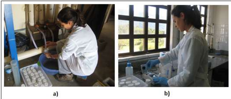
Figura 18 - Controle de turbidez na lavagem: a) coleta de água da retrolavagem; b) análise de turbidez
