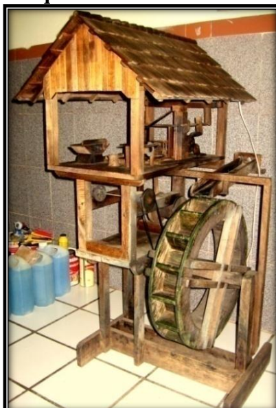
Figura 04 - Maquete de serraria movida a água, s.d.
