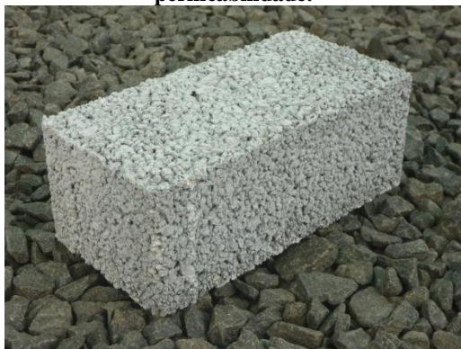
Figura 40. Bloco retangular drenante, com alta refletância solar e alta permeabilidade.
