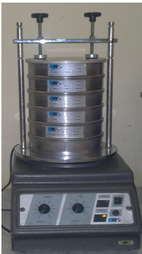
Figura 27. Equipamento de Vibração Granutest. Fonte: Registro fotográfico do autor, 2014.
