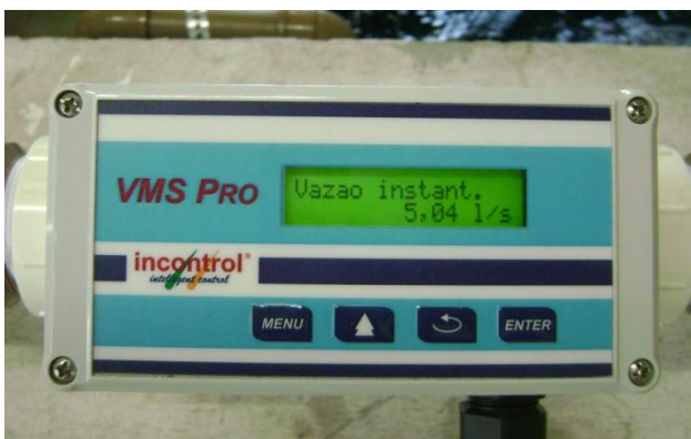
Figura 12 - Medidor automático de vazão eletromagnético
