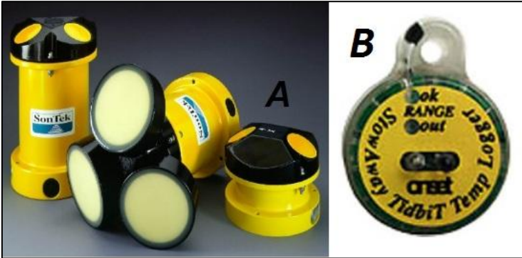
Figura 21 - Detalhe dos equipamentos que foram utilizados no levantamento dos dados. A) Perfilador acústico de correntes; B) Termômetro.
