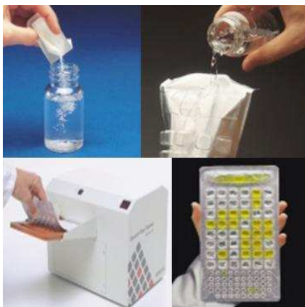
Figura 9 - Procedimento para análise de coliformes totais e E.coli (IDEXX, 2010)
