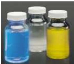
Figura 10 - Coloração resultante da reação enzimática ONPG/MUG (IDEXX, 2010)
