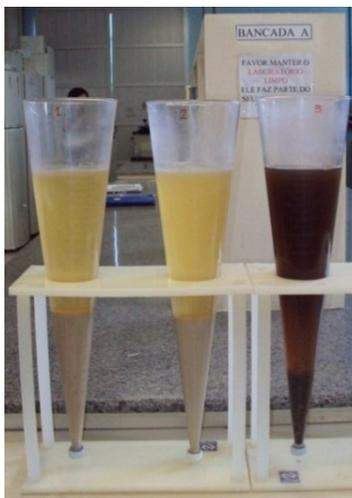
**Figura 8 – Ensaio de Sedimentação. Cone 1 (hidróxido de cálcio), Cone 2 (cal hidratada) e Cone 3 (hidróxido de sódio)**
