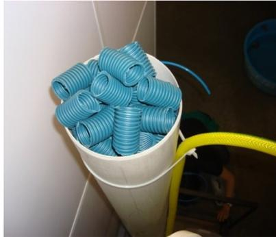
Figura 5 - Recheio da torre de *air stripping*.
