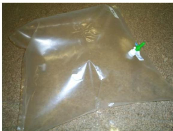
Figura 13 - Saco Tedlar utilizado para amostragem
