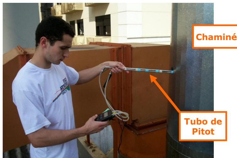
Figura 11 – Medição da velocidade.
