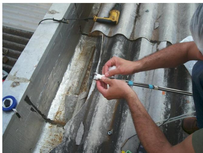
Figura 12 – Fixação de algodão na ponta do Pitot.
