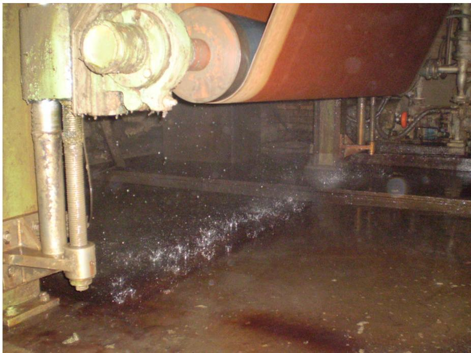
**Figura 14 – Ponto 1: Vazamento da lavagem das telas.**
