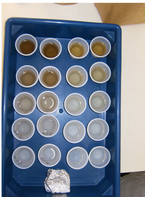
Figura 10 – Exemplo de montagem de um teste de toxicidade aguda
