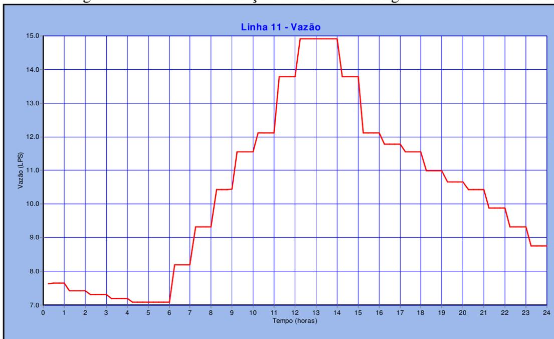
**Figura 5.14 – Variação de vazão no trecho 11**
