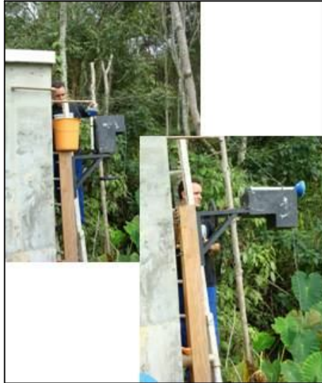
Figura 26 – Foto da simulação de enchimento e tombamento do equipamento.
