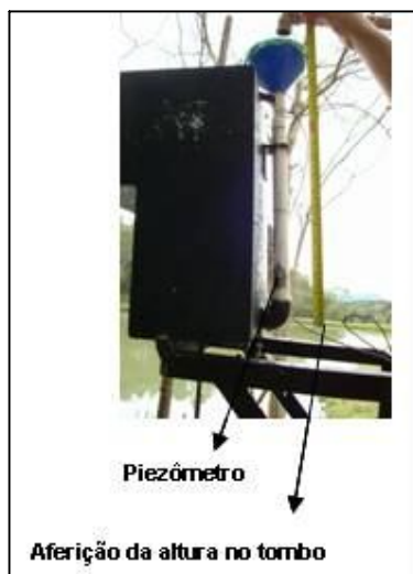
Figura 31 – Localização do piezômetro para medição da altura no tombamento com o equipamento ajustado.
