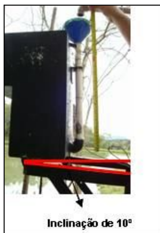
Figura 25 – Foto da inclinação do equipamento em relação a base horizontal.
