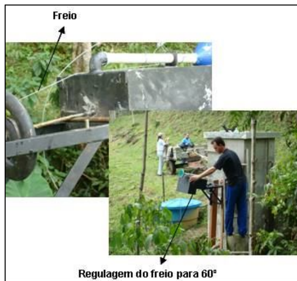
Figura 29 – Foto da alocação do freio e regulagem da caixa para aproximadamente 60°.
