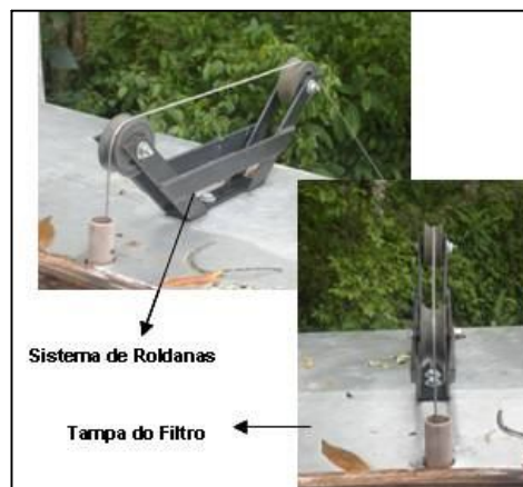
Figura 10 – Foto do sistema de roldanas sobre a tampa do filtro.
