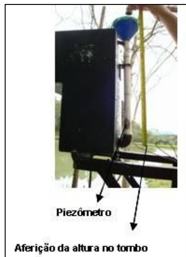
Figura 27 – Foto da localização do piezômetro para medição da altura no tombamento.
