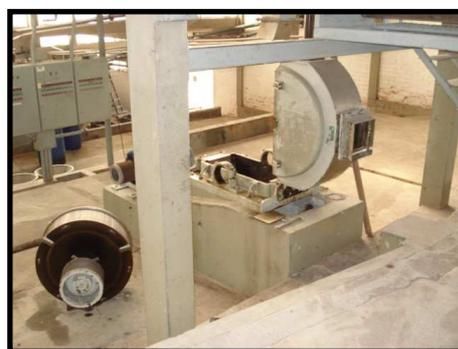
**Figura 11:** dosador e desintegrador
