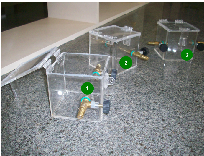
Figura 4 – câmaras de acrílico utilizadas nos ensaios ecotoxicológicos, onde: 1= câmara de controle positivo; 2= câmara de controle negativo e 3= câmara de contato com os compostos orgânicos analisados.
