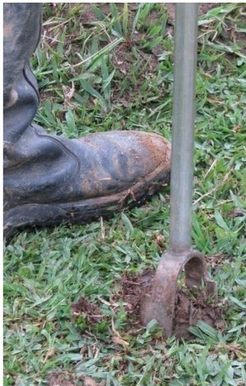
**Figura 4.** Tradagem para coleta de amostra deformada.
