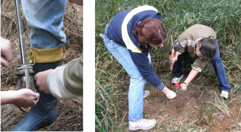
**Figura 5.** Coleta de amostra não-deformada.
