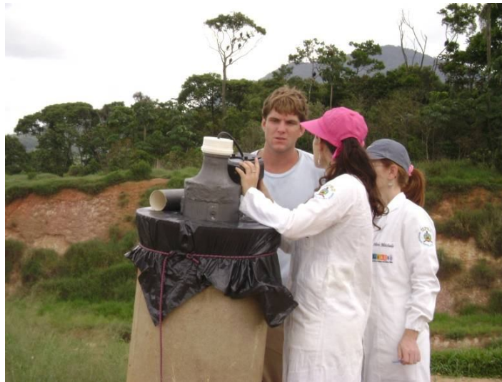
Figura 16 - Equipe medindo vazão do biogás, com dreno vedado, bocal com curva normalizada e utilizando o aparelho Dräger.
