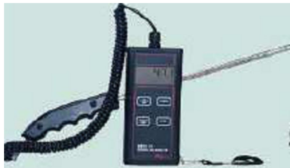
Figura 14 - Aparelho termo-anemômetro utilizado em campo para medição de velocidade e temperatura
