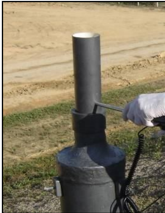
Figura 15 - Medição de velocidade e temperatura com bocal reduzido.
